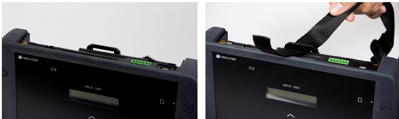
Figura 7: Montaż pasa do mocowania: Krok 1 i 2.
