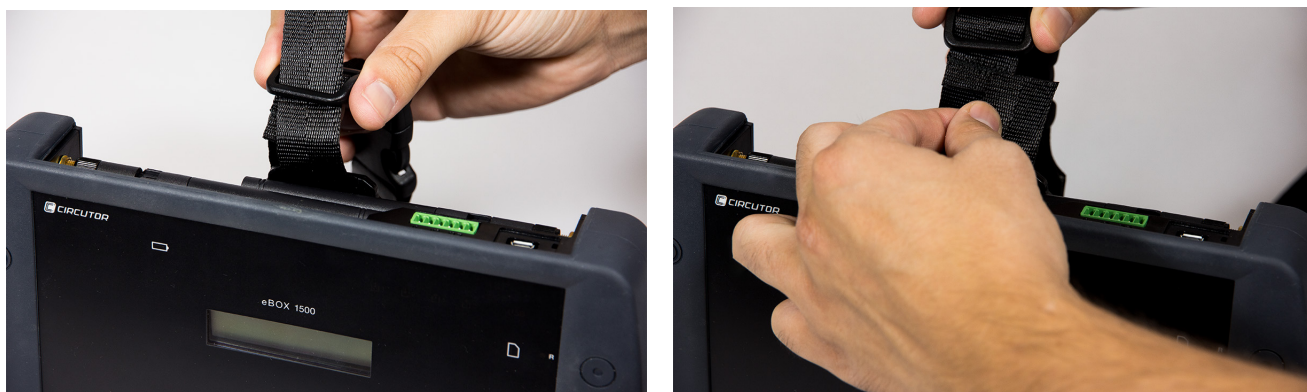
Figura 8: Montaż pasa do mocowania: Krok 3 i 4.
