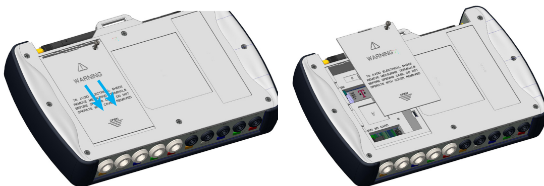
Figura 2: Zdjęcie pokrywy z akumulatora.
