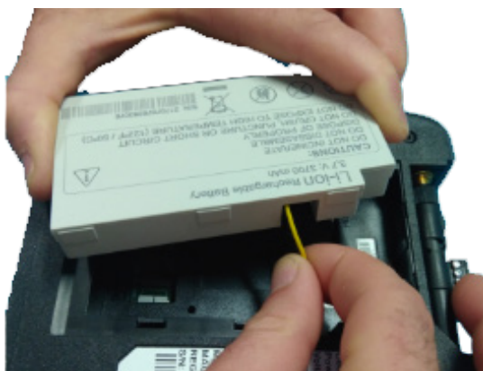
Figura 4: Włóż kabel połączeniowy do pokrywy akumulatora.
