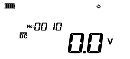
Rysunek 13.21 Pomiar napięcia AC/DC (interfejs domyślny)
