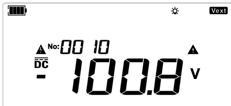
Rysunek 13.24 Pomiar ujemnego napięcia prądu przemiennego (DC)
