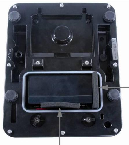
⇒ Inserir a pilha de tal maneira que não tenha possibilidade de deslizamento (bloquear com elementos de espuma).
