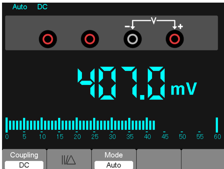
Figura 7-6 Medição de Tensão DC
