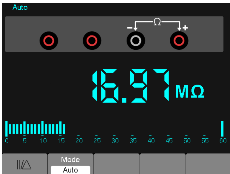
Figura 7-2 Medição de Resistência
