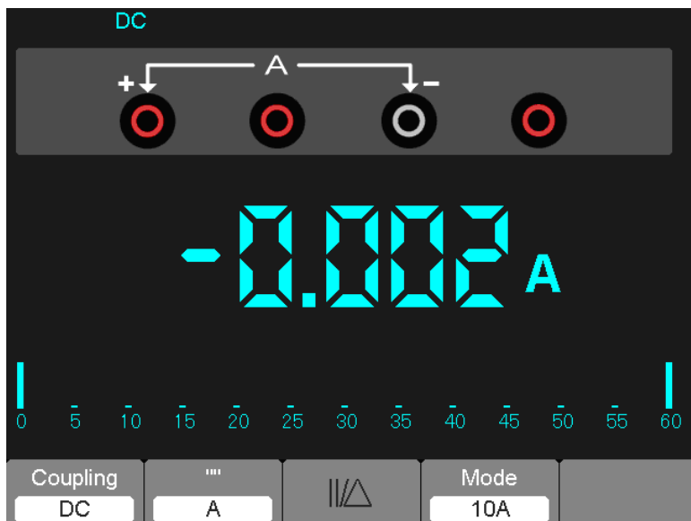
Figura 7-9 Medição de Corrente DC para 10 A
