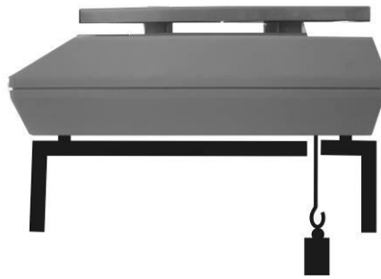
Fig. 1: Preparação da balança para a pesagem suspensa
