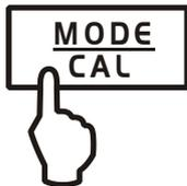
Esta função permite lembrar o peso do recipiente de tara. A balança continua funcionando com valor da tara memorizado também depois do desligamento e religamento.
