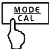
⇒ Descarregar a balança e pressionar algumas vezes a tecla **MODE**, até a indicação „PtArE” surgir piscando.
