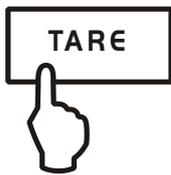
⇒ Descarregar a balança e pressionar a tecla **TARE**, a indicação de zero aparecerá.
