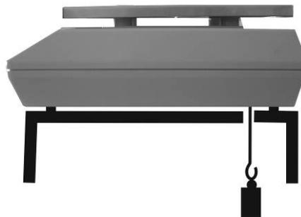
Ilustr. 1: Preparação da balança para pesagens suspensas
