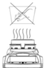
2. Remover da proximidade direta os materiais com risco de explosão e inflamáveis. Vapores que se exalam, prato para a pesagem de amostras e todos os elementos da câmara de amostras estão quentes.
