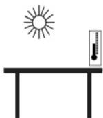
1. Evitar temperaturas extremas, como também oscilações de temperatura que podem surgir p.ex. próximo a aquecedores ou em locais expostos diretamente a ação dos raios solares.
