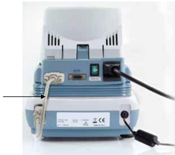
O dispositivo pode ser conectado só à tomada com pino de cabo protetor (PE), instalada de acordo com as leis. Ação protetora não pode ser perturbada como resultado de emprego do cabo de prolongamento sem cabo de proteção. No caso de alimentação da rede sem pino do cabo de proteção, um especialista adequado deve criar uma proteção equivalente de acordo com regulamentos vigentes relativos à instalação.
