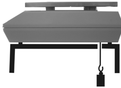
Fig. 1: Preparação da balança para a pesagem suspensa
