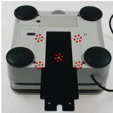
Para desmontar a chapa de montagem, retirar os parafusos marcados desaparafusando-os.
