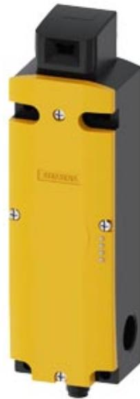
chave de posição de segurança com dispositivo de retenção torque de aperto 1300 N 5 direções de arranque carcaça de plástico, conector de encaixe M12 ASIsafe integrado canal 1=no 1NF do atuador canal 2=em 1NF do atuador bloqueado por força magnética tensão magnética CA/24 V CC motonitoramento do atuador 2NF/1NA motonitoramento do imã 2NF/1NA do adequado separado atuador 3SE5000-0AV0 deve ser encomendado separadamente
