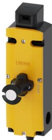
chave de posição de segurança com dispositivo de retenção torque de aperto 1300 N 5 direções de arranque carcaça de plástico, conector de encaixe M12 ASIsafe integrado canal 1=atuador 2NF segundo o princípio da avaliação 2v2 canal 2=imã 1NF força da mola travada desbloqueio de fuga dianteiro tensão magnética 24 V CC/CA motonitoramento do atuador 2NF/1NA motonitoramento do imã 2NF/1NA do adequado separado atuador 3SE5000-0AV0 deve ser encomendado separadamente
