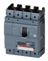
Leistungsschalter 3VA6 UL Frame 400 Schaltvermögenklasse M 35kA @ 480V 4-polig, Anlagenschutz ETU856, LSI, In=400A Überlastschutz Ir=160A...400A Kurzschlussschutz Isd=0,6..10x In, Ii=1,5..10x In N-Leiterschutz einstellbar (OFF, bis 100%) Erdschlussalarm Meldung über EFB300 o. COM ohne Anschluss
