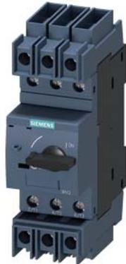
Leistungsschalter Baugröße S00 für den Trafoschutz mit Approbation circuit-breaker UL 489, CSA C22.2 NO.5-02 A-Auslöser 1,6 A N-Auslöser 33 A Schraubanschluss Standardschaltvermögen
