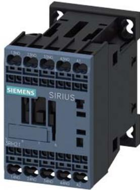
Hilfsschütz, 4 S, AC 220 V, 50 Hz, 240 V, 60 Hz, Baugröße S00, Federzuganschluss
