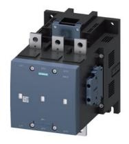
Vakuumschütz, AC-3 500 A, 250 kW / 400 V AC (50-60 Hz) / DC-Betätigung AC/DC 110-127V Hilfskontakte 2 NO + 2 NC 3-polig, Baugröße S12 Schienenanschlüsse Antrieb: konventionell
