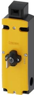
Sicherheits-Positionsschalter mit Zuhaltung Zuhaltkraft 1300 N 5 Anfahrichtungen Federkraftverriegelt Hilfsentriegelung mit Schloss Magnetspannung AC 230 V Überwachung Betätiger 2Ö/1S Überwachung Magnet 2Ö/1S LED-Anzeige gelb/grün Lieferung ohne Betätiger. Betätiger 3SE5000-0AV0. bitte separat bestellen
