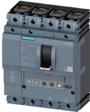
Leistungsschalter 3VA2 IEC Frame 160 Schaltvermögenklasse H Icu=85kA @ 415V 4-polig, Anlagenschutz ETU330, LIG, In=40A Überlastschutz Ir=16A...40A Kurzschlusschutz Ii=1,5...12 x In N-Leiterschutz einstellbar (OFF, 100%) Erdschlusschutz Ig=0,4...1 x In= tg=0,1/0,3s Klemmenanschluss
