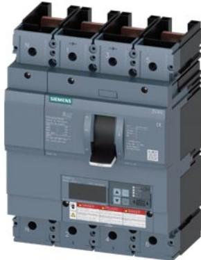
Leistungsschalter 3VA6 UL Frame 400 Schaltvermögenklasse M 35kA @ 480V 4-polig, Anlagenschutz ETU820, LI, In=250A Überlastschutz, 100% rated Ir=100A...250A Kurzschlusschutz li=1,5...12 x In ohne Anschluss
