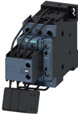
Kondensatorschütz, AC-6b 25 kVA<sub>r</sub>, / 400 V 1 S + 2 Ö, DC 24 V 3-polig, Baugröße S0 Schraubanschluss
