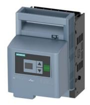
SENTRON, Sicherungslasttrennschalter 3NP1, 3-polig, NH000, 160 A, für Aufbau und Einbau auf Montageplatte, Rahmenklemme, Sicherungsüberwachung: elektronisch EFM20, Abdeckebene 45mm
