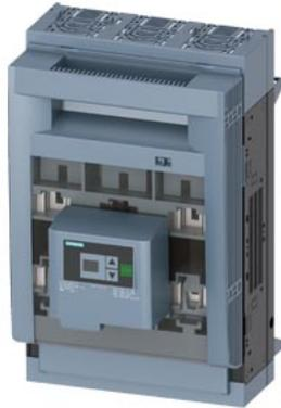
SENTRON, Sicherungslasttrennschalter 3NP1, 3-polig, NH1, 250 A, für Sammelschienensystem Rittal 60mm, Flachanschluss, Sicherungsüberwachung: elektronisch EFM20, Abdeckebene 32/70mm
