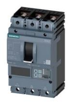
Leistungsschalter 3VA2 IEC Frame 100 Schaltvermögenklasse L lcu=150kA @ 415V 3-polig, Anlagenschutz ETU560, LSIG, ln=63A Überlastschutz Ir=25A...63A Kurzschlussschutz Isd=0,6..10x ln, li=1,5..12x ln N-Leiterschutz optional mit externem Stromwandler, bis 160% Erdschlussschutz, abschaltbar Ig=0,25...1 x ln, tg=0,05-0,8s Schraubenflachanschluss
