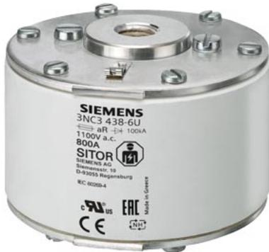
SITOR-Sicherungseinsatz, mit beidseitigem Innengewinde, NH3, In: 800 A, aR, Un AC: 690 V, Un DC: 440 V, Stirnkennmelder
