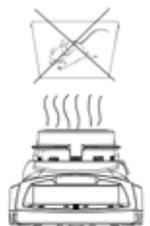
2. Удалить из непосредственного окружения взрывоопасные и легко воспламеняемые материалы. Выделяющиеся испарения, чаша весов для образцов и все элементы камеры образцов горячие.
