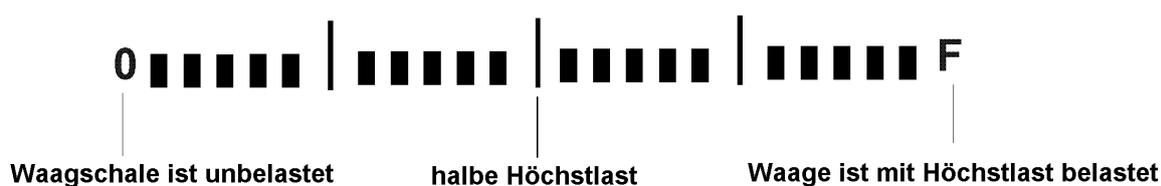
Диапазон взвешивания весов разделен на 20 графических кадров. Если на весах отсутствует значение веса, то на графическом индикаторе выводится нуль (0). Если весы нагружаются до половины своего диапазона взвешивания, то выводятся 10 графических кадров.
