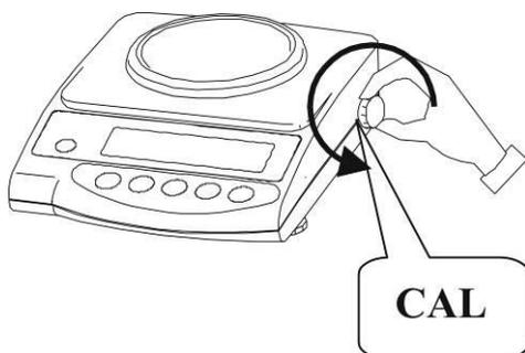
Идет автоматическая юстировка. Происходит мигающее высвечивание показания **[CAL.on]**.
