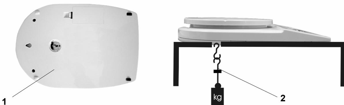
Рис. 1: Настройка весов для взвешивания с нижней стороны весов
