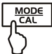
С помощью этой функции производится сохранение веса тары. И после выключения/включения весы также продолжают работать с сохраненным значением тары.
