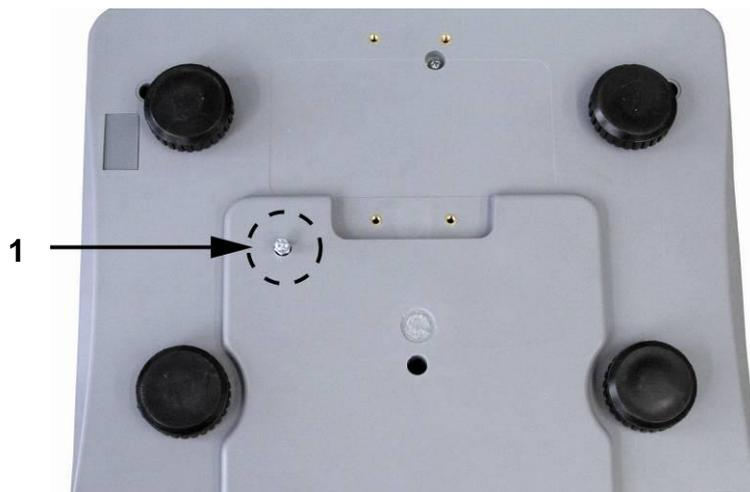
Для ослабления транспортного предохранения вывинтите транспортный болт (1) в направлении, противоположно м движению часовой стрелки.
