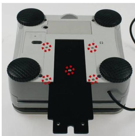
Для демонтажа монтажного листа удалить отмеченные болты, вывинчивая их. Затем дисплей можно установить отдельно.
