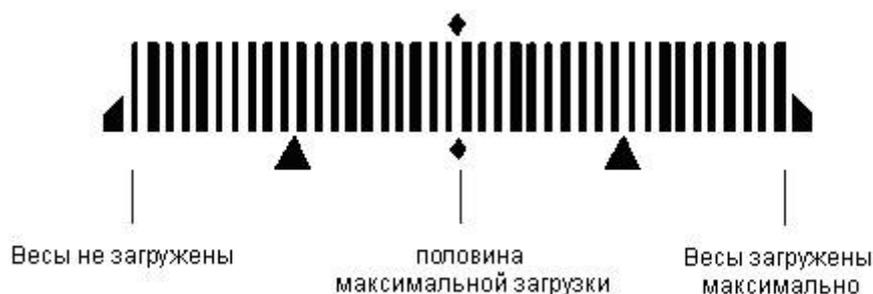
Предел взвешивания весов поделен на 40 графических прямоугольных параллелепипедов. Если весы не загружены, то на графическом индикаторе высвечивается ноль (0). Если весы будут загружены до половины диапазона взвешивания, то высвечивается 20 прямоугольных параллелепипедов графического изображения.
