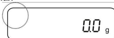
Если на дисплее видим показатель стабильности [o], весы находятся в стабильном состоянии. В состоянии нестабильном индикатор [o] исчезает.
