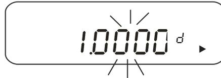
Ввод плотности происходит с помощью клавиши TARE и клавиши F, запись в памяти с помощью клавиши S (смотри „Ввод температуры”)
