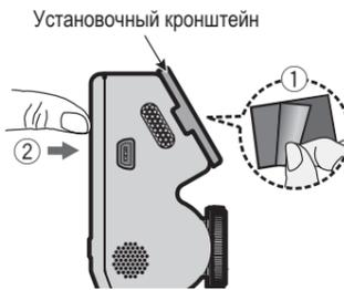
⚠ Будьте предельно осторожны, потому что двусторонняя клейкая лента на установочном кронштейне (1) обладает очень высокой клеящей способностью и ее будет трудно переклеить после применения.
