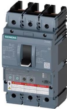
Leistungsschalter 3VA6 UL Frame 150 Schaltvermögenklasse C 100kA @ 480V 3-polig, Anlagenschutz ETU330, LIG, In=100A Überlastschutz Ir=40A...100A Kurzschlusschutz Ii=1,5...12 x In Erdschlusschutz Ig=0,2...1 x In, tg=0,1/0,3s ohne Anschluss
