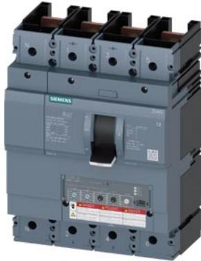
Leistungsschalter 3VA6 UL Frame 400 Schaltvermögenklasse H 65kA @ 480V 4-polig, Anlagenschutz ETU330, LIG, In=250A Überlastschutz, 100% rated Ir=100A...250A Kurzschlusschutz li=1,5...12 x In N-Leiterschutz einstellbar (OFF, 50%, 100%) Erdschlusschutz Ig=0,2...1 x In= tg=0,1/0,3s ohne Anschluss
