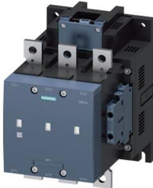
Vakuumschütz, AC-3 300 A, 160 kW / 400 V AC (50-60 Hz) / DC-Betätigung AC/DC 96-127V Hilfskontakte 2 NO + 2 NC 3-polig, Baugröße S10 Schienenanschlüsse Antrieb: elektronisch mit SPS-Schnittstelle DV 24 V
