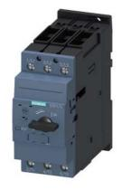
Leistungsschalter Baugröße S2 für den Motorschutz, CLASS 20 A-Auslöser 32...40 A N-Auslöser 585 A Schraubanschluss Standardschaltvermögen
