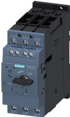
Leistungsschalter Baugröße S2 für den Motorschutz CLASS 20 A-Auslöser 32...40 A N-Auslöser 585 A Schraubanschluss Standardschaltvermögen mit querliegendem Hilfsschalter 1S+1Ö
