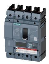
Leistungsschalter 3VA6 UL Frame 150 Schaltvermögenklasse H 65kA @ 480V 4-polig, Anlagenschutz ETU830, LIG, In=150A Überlastschutz, 100% rated Ir=60A...150A Kurzschlussschutz Ii=1,5...10 x In Erdschlussschutz Ig=0,2...1 x In, tg=0,05-0,8s ohne Anschluss
