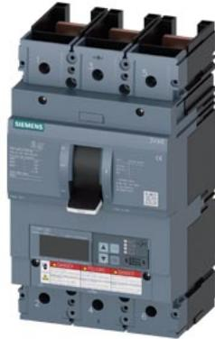
Leistungsschalter 3VA6 UL Frame 400 Schaltvermögenklasse L 150kA @ 480V 3-polig, Anlagenschutz ETU560, LSIG, In=250A Überlastschutz Ir=100A...250A Kurzschlusschutz Isd=0,6..10x In, li=1,5..12x In N-Leiterschutz optional mit externem Stromwandler, bis 160% Erdschlusschutz Ig=0,2...1 x In, tg=0,05-0,8s ohne Anschluss
