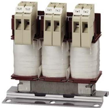
NETZDROSSEL F. FU; PHASEN:3; UN1(V):480; ITHMAX 1(A) / F1(HZ):6,3 /60; I LN (A):5,67; UK(%):2; LN(MH):2,24; TA/ISOKL:40 /B; IP00; ANSCHLUSS: SCHRAUB- /FLACHSTECK- ANSCHLUSS; EN 61558-2-20 >UL/CSA-RECOGNIZED< >DROSSEL<
