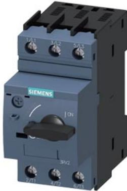
Leistungsschalter Baugröße S0 für den Motorschutz, CLASS 10 A-Auslöser 1,4...2 A N-Auslöser 26 A Schraubanschluss Standardschaltvermögen
