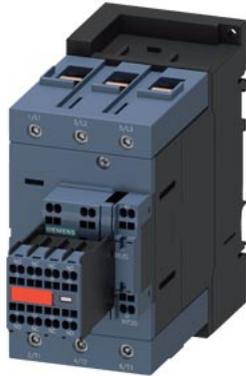
Schütz, AC-3, 55 kW/400 V 2S+2Ö, AC 110 V 50 Hz 3-polig, 3S, Baugröße S3 Federzuganschluss Varistor eingesteckt Hilfsschalter unlösbar
