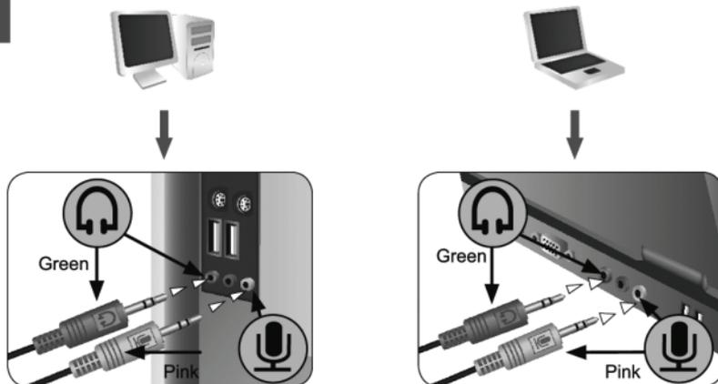
Снимите защитный колпачок и подсоедините штекер гарнитуры к звуковой карте. Штекер наушников должен быть подсоединен к выходу для динамиков, а штекер микрофона к входу для микрофона звуковой карты.
