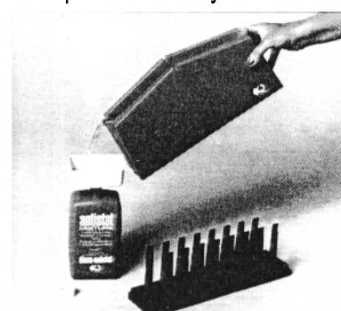
Po použití může být zbytek roztoku pomocí trychtýře nalít zpět do láhve. Roztok ANTISTAT-MIXTURE může být použit několikanásobně. Náhradní láhve s roztokem lze koupit v obchodě.
