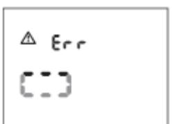
Merilno orodje ima interni napako in se po 5 sekundah samodejno izklopi. Za ponastavitev programske opreme odstranite baterije, počakajte nekaj sekund in ponovno vstavite baterije.
