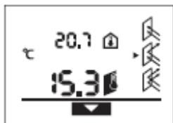
Za preklop v način toplotnega mosta pritisnite tipko način toplotni most **10**. Na prikazovalniku se prikaže **j** za potrditev.
