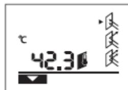
Za preklop v način površinske temperature pritisnite tipko način površinska temperatura **11**. Na prikazovalniku se prikaže **k** za potrditev.
