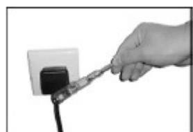
Za hiter test vtičnic, napajalnikov ali PVC izoliranih kablov držite tester na merilni konici (1) in dajte držalo v bližino naprave za preveritev. Pri prisotni napetosti LED (2) prične utripati.
