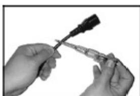
Merilno konico testerja vodite vzdolž električnega kabla, vtičnice ali naprave.
