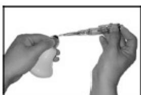
Z eno roko se dotaknite pokrova predala za baterije (3) in z drugo roko se dotaknite kontakta gradbenega dela za preveritev (npr. žarnica). Konico multitestra dajte na drug kontakt. Če prične LED (2) utripati, potem je prevodnost prisotna, oziroma žarnica je v redu. Multitester prepozna upornosti do 50 MΩ. S to funkcijo lahko preprosto in nezapleteno preverite varovalke, upore (do 50 MΩ), grelne elemente, gradbene dele, kot so kondenzatorji, tranzistorji, diode, tuljave, itd.
