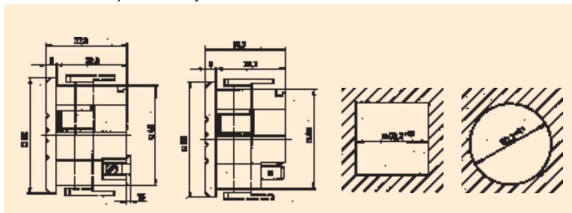
**Sprednji okvir 48 x 48 mm, izrez stikalne plošče Ø 45,2 <sup>+0,3</sup> mm**
