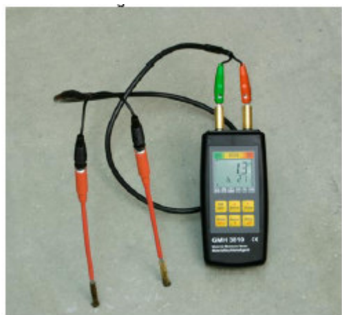
Merjenje vlažnosti s ščetkastimi sondami
