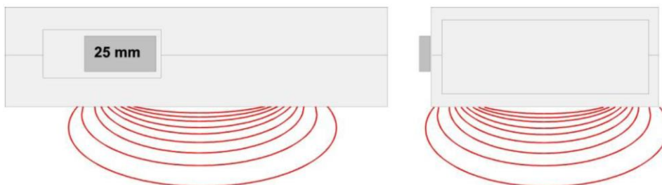
Pogled s strani: merilno polje in globina vdora pri položaju stikala „25 mm“
