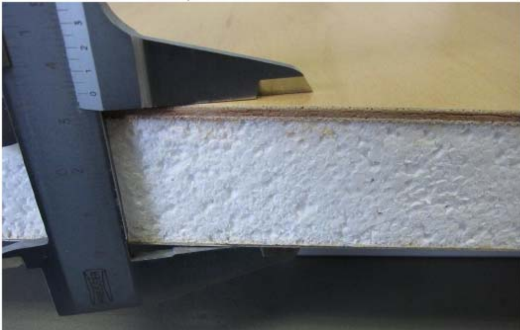
Primer večplastnega ohišja: aluminij – izolacija – vezan les
