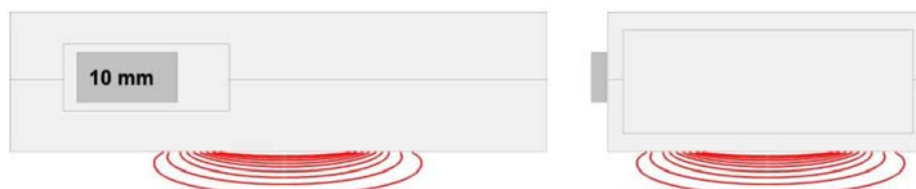
Pogled s strani: merilno polje in globina vdora pri položaju stikala „10 mm“
