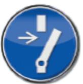
Med delom na napravi se prepričajte, da je sistem/stroj, v katerega je naprava nameščena, izklopljen iz električnega omrežja in ga ni mogoče ponovno vklopiti.
